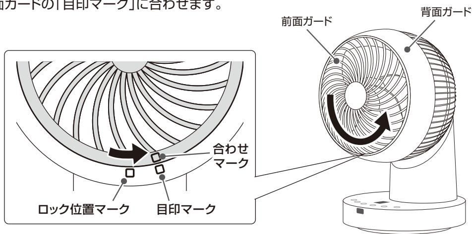
※前面ガードを取り付けるときは、前面ガード下部の「合わせマーク」を背面ガードの「目印マーク」に合わせてはめ込み、「ロック位置マーク」に向けて『カチッ』と音がするまでしっかりと回してください。
