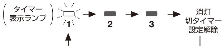
設定時間が経過すると、通電が止まり『電源/温度調節ダイヤル』部が点滅してお知らせします。
