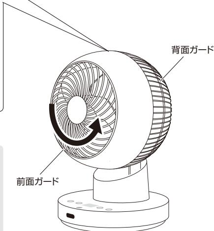
※前面ガードを取り付けるときは、前面ガード上部の「合わせマーク」を背面ガードの「目印マーク」に合わせてはめ込み、「ロック位置マーク」と「目印マーク」がまっすぐ揃うようにしっかりと回してください。
