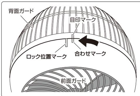
※前面ガードを取り付けるときは、前面ガード上部の「合わせマーク」を背面ガードの「目印マーク」に合わせてはめ込み、「ロック位置マーク」と「目印マーク」がまっすぐ揃うようにしっかりと回してください。
