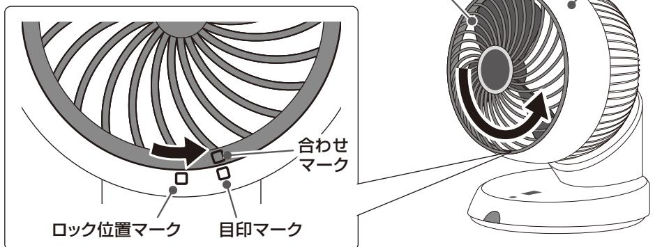
※前面ガードを取り付けるときは、前面ガード下部の「合わせマーク」を背面ガードの「目印マーク」に合わせてはめ込み、「ロック位置マーク」に向けて『カチッ』と音がするまでしっかりと回してください。
