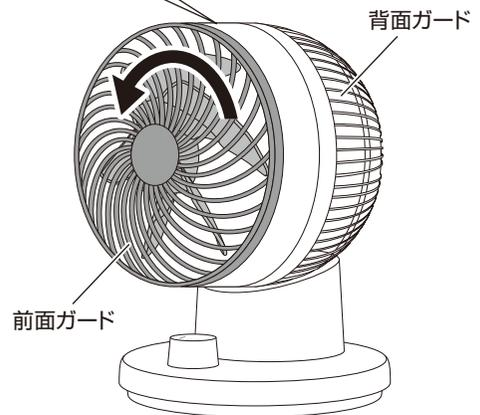
※前面ガードを取り付けるときは、「▲マーク」を背面ガードの「🔒マーク」の方向に回して取り付けてください。
