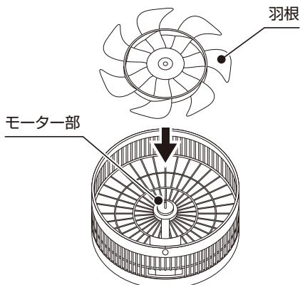
②スピンナーを「」方向に回して取り付けます。
