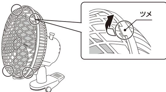
お手入れ後は、後ガードに前ガードを合わせ、ツメの内側に入るように1カ所ずつ押し込んで取り付けてください。
